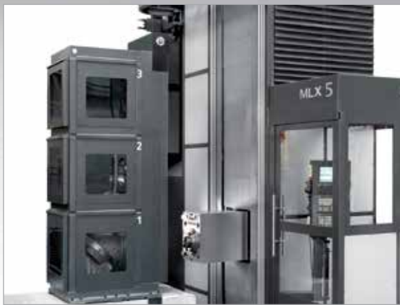
▲ MLX: Automatic head changing system. MLX: Automatisches Kopfwechselsystem.
