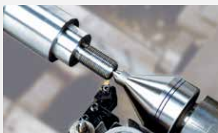
Den forlengede spissen garanterer den nødvendige frivinkelen ved dreining av deler med liten diameter.
