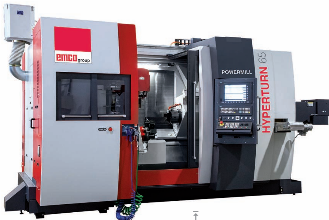
↑ EMCO HYPERTURN POWERMILL HT65-PM Millturn-versjon av Hyperturn, med vribar B-akse og verktøymaskin.
